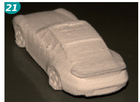
Bild 21 • Gesintertes Bauteil, deformiert
