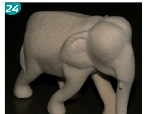
Bild 21 • Gesintertes Bauteil, deformiert
