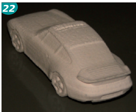
Bild 22 • Mit Stützform gesintertes Bauteil, nicht deformiert
