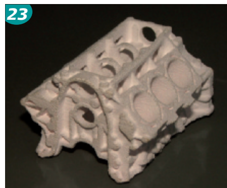
Bild 23 • Gesintertes Motorblock aus \text{Al}_2\text{O}_3
