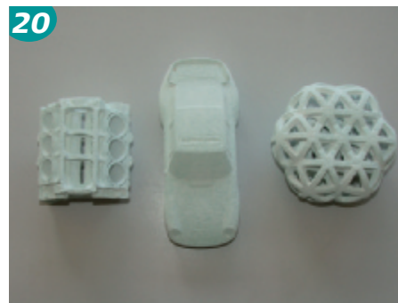
Bild 20 • Druckluft gereinigte Bauteile
